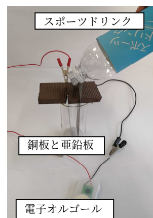
図８ ジュース電池の実験
