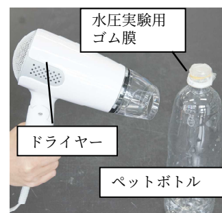
図5 ふくらむゴム膜の実験
