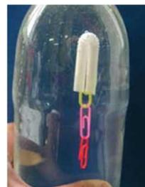
ペットボトルを押すことによって沈む浮沈子
