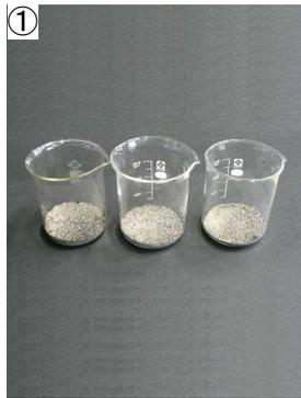
砂と土を4：1の割合で混ぜた物をビーカーに入れる（同じ物を約3個用意する。※砂と土はざるやふるいを用い、粒の大きな物を取り除いておく。
