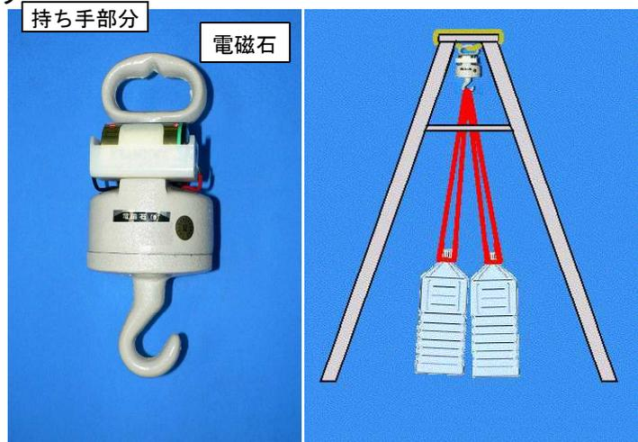
理科室に右のような電磁石はありませんか。このタイプの電磁石は、乾電池を取り付けると、持ち手部分（電磁石）がつり下げ部分（鉄の板）を強力に引き付け、数十kgの物（写真の電磁石は約60kg）をつり下げることができる。この電磁石に水の入ったペットボトル（5個程度）をつり下げの実験を行うことで、電磁石に対する関心を高めることができる。
