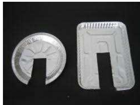
アルミニウムのトレーだと、金属板に比べてコの字型も簡単に加工できる。
