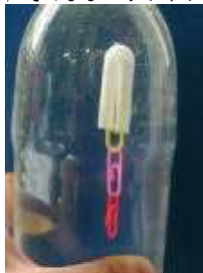
ペットボトルをおすことによって沈む浮沈子
