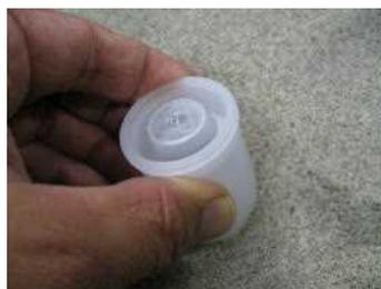
③静かに持ち上げると砂鉄がつき、ケースを上下にふると、砂鉄が落ちる。
