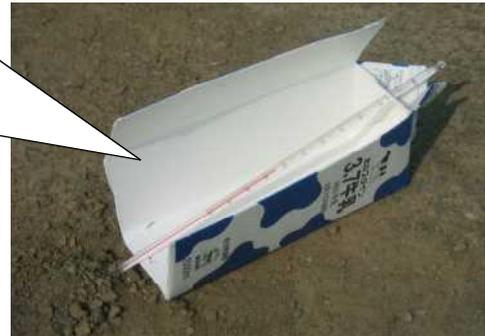
牛乳パックを上のように切り開き、棒温度計を差し込む穴を開ける。
