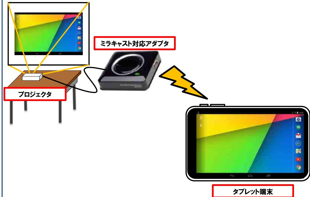
※ タブレット端末の画面が、ミラキャスト対応アダプタを経由してプロジェクタに出力されます。
